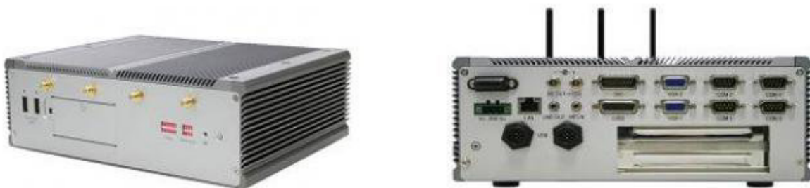
Slika 4: Komunikacijski modul za slanje podataka o kretanju autobusa
