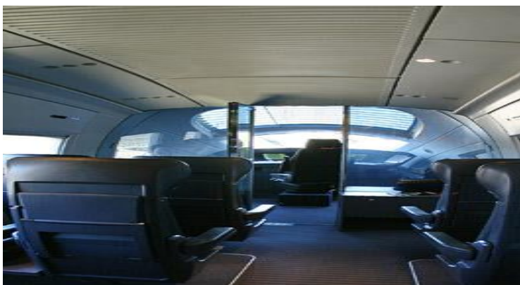
Slika 4. Stakleni zid između strojovođe i putnika u posebnom odjeljku
