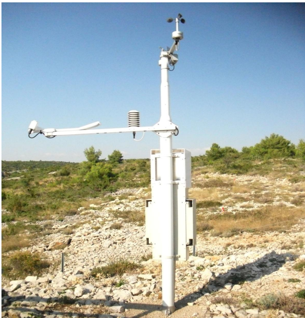
Slika 2. Cestovna automatska meteorološka stanica pokraj autoceste A1 Zagreb-Split, na dionici Šibenik-Pirovac.
