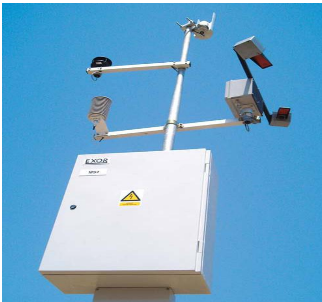
Slika 13. TRAFIS MS101 cestovna meteorološka stanica.
