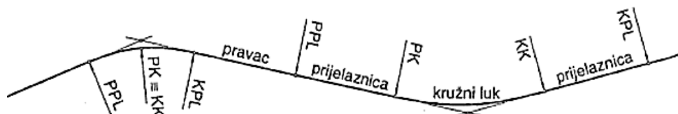
Slika 16. Tlocrtni elementi ceste
