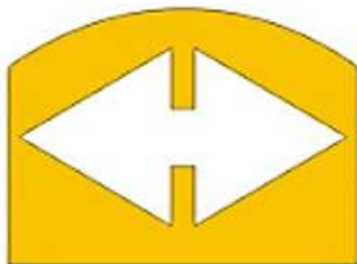
Slika 72. Ploče za označavanje vrha razdjelnog otoka
