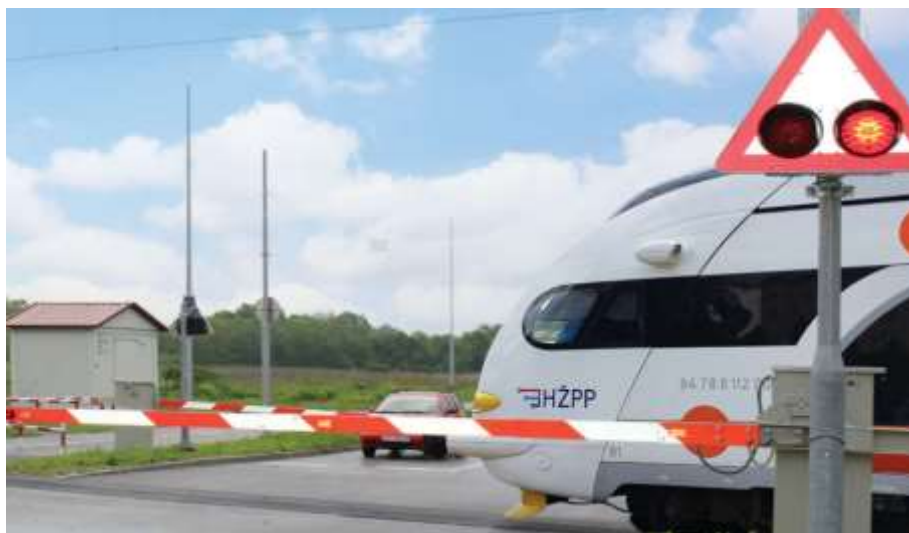
Slika 54. Prometna svjetla za označavanje prijelaza preko željezničke pruge Izvor: https://npscp.info/vijesti/item/484-savjeti-sigurne-voznje-prelazak-preko-pruge-trazi-visoku-razinu-pozornosti
