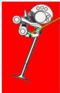
Slika 2.49. Primjeri dinamičkog opterećenja (klackalica za otvaranje ventila kod motora s unutarnjim izgaranjem opterećena je na pulzirajuće naprezanje na savijanje) i titrajućeg (osovina vagona opterećena je na izmjenično naprezanje na savijanje)
