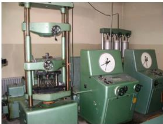
Slika 2.22. Kidalica i dijagram kidanja
