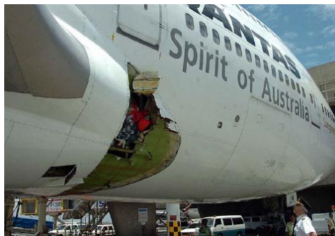
Slika 2.46. Primjer oštećenja zbog umora
