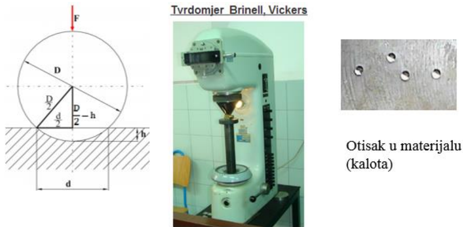
Slika 2.38. Mjerenje tvrdoće prema Brinellu
